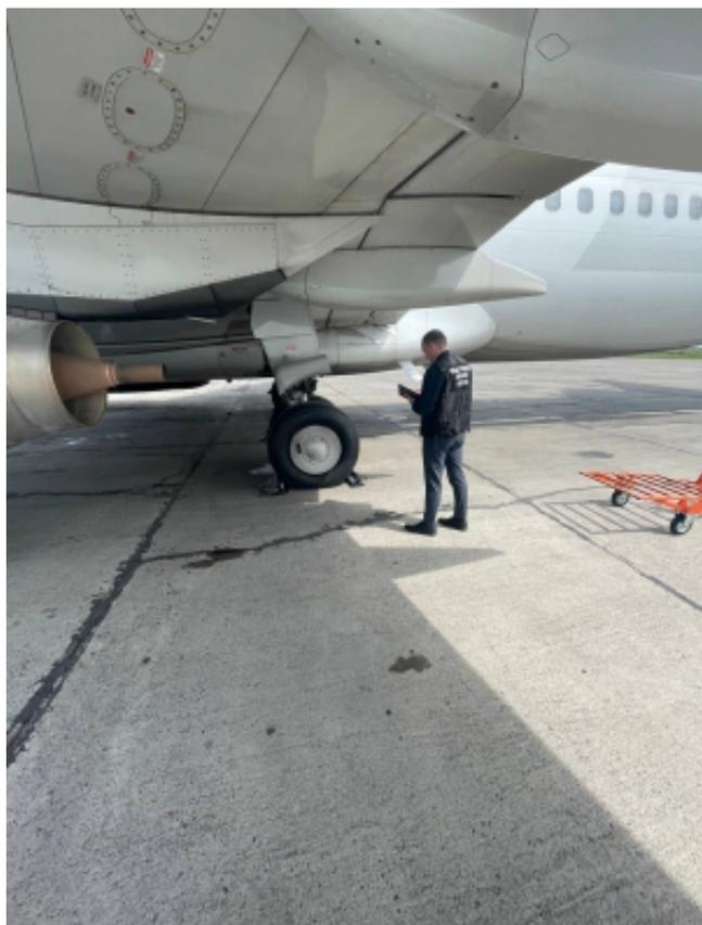
Установлено, что 29 мая 2023 года самолет "Боинг 737" при буксировании тягачом к месту начала взлета левой стойки шасси выехал за край взлетной полосы в г. Новокузнецке и осел. После высадки пассажиров самолет был отбуксирован на место стоянки.
