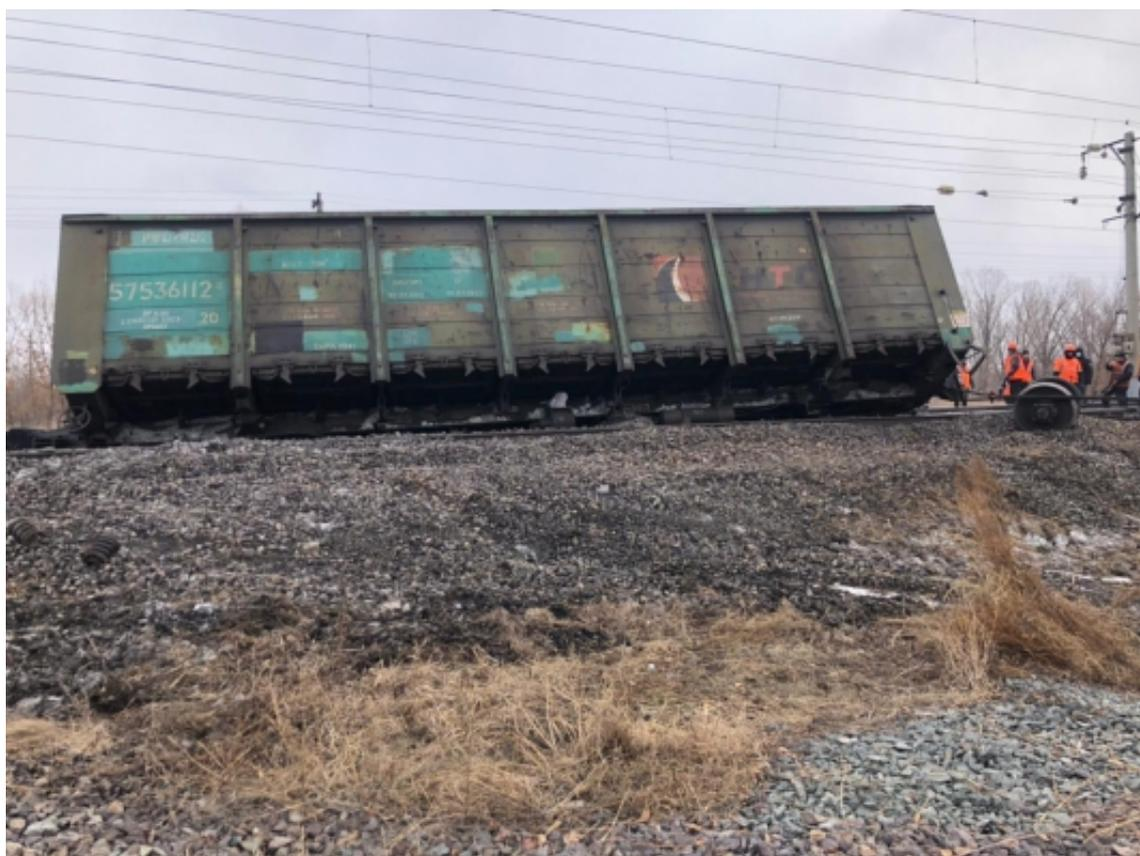
6 марта 2022 года утром на станции Перелётный, двухпутного электрифицированного участка Сибирцево – Владивосток Дальневосточной железной дороги, произошло падение давления в тормозной магистрали, в результате чего допущен сход 8 железнодорожных вагонов, груженных углем.
